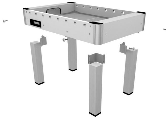
Positionner l'équerre à l'intérieur de la partie inférieure du baby-foot et placer les pieds en aluminium et ensuite serrer le tout avec la clé à lenne les vis de 8x45 et les rondelles de 8x32 du coté extérieur et les platines écrou à l'intérieur.
